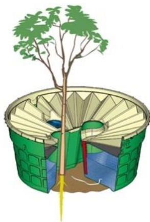
Schematische afbeelding van de Waterboxx
